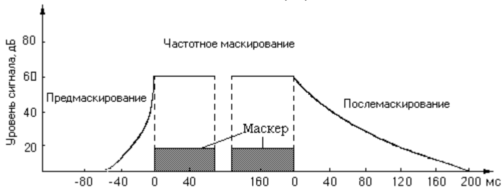
Рис. 6.11. Зависимость изменения порога слышимости маскируемого сигнала от величины временного интервала между сигналом и маскером
